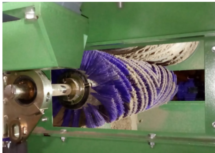
Cepillo limpiador rotativo para bandas nervadas y chevron
