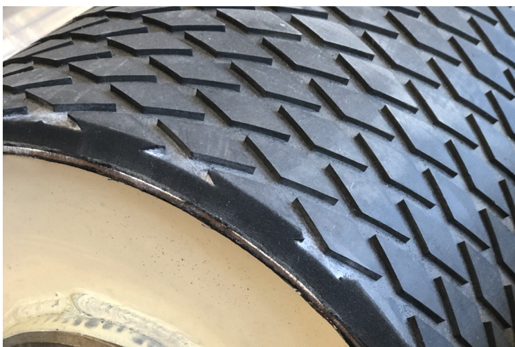
Recubrimiento en frío con acabado rombo
